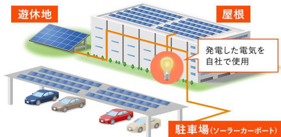
自家消費型太陽光発電の仕組み(イメージ図)
